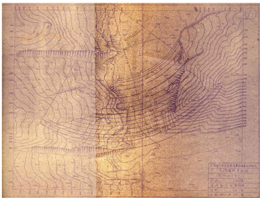
圖九~圖十 推測為戰前設計、戰後重繪之石門大壩設計斷面圖及平面圖，採用重力式拱型混凝土壩形式設計
